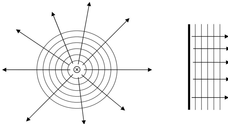
Figura 9: frentes de onda circular (a) y plano (b)
