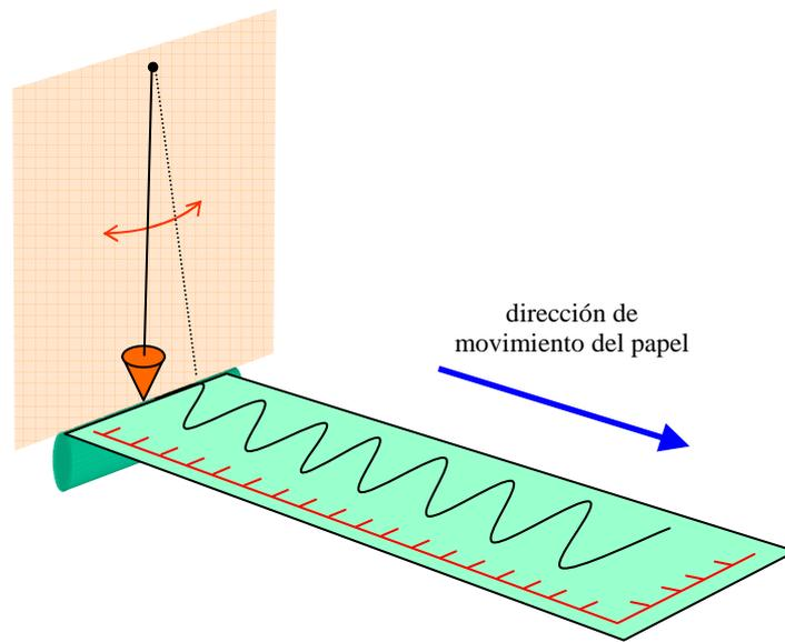
Figura 3: trazo de arena de un péndulo sobre una cinta transportadora moviéndose con rapidez constante.
