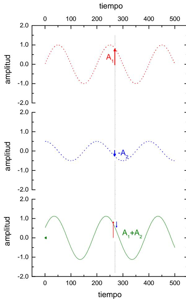
Figura 15: superposición de dos ondas sinusoidales de igual frecuencia, amplitudes  $A_1$  y  $A_2$  distintas y desfasadas entre sí en  $\phi_2 - \phi_1 = \pi/2$
