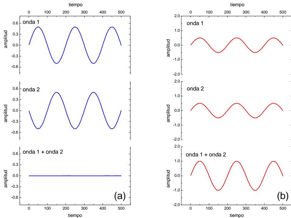
Figura 16: tipos de interferencia: (a) destructiva y (b) constructiva
