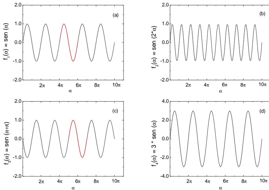
Figura 7: Diferentes funciones sinusoidales.
