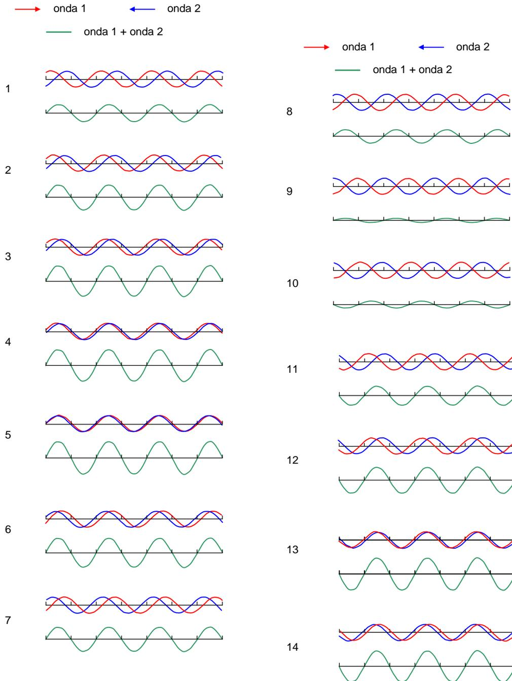
Figura 19: ondas estacionarias en una cuerda.
