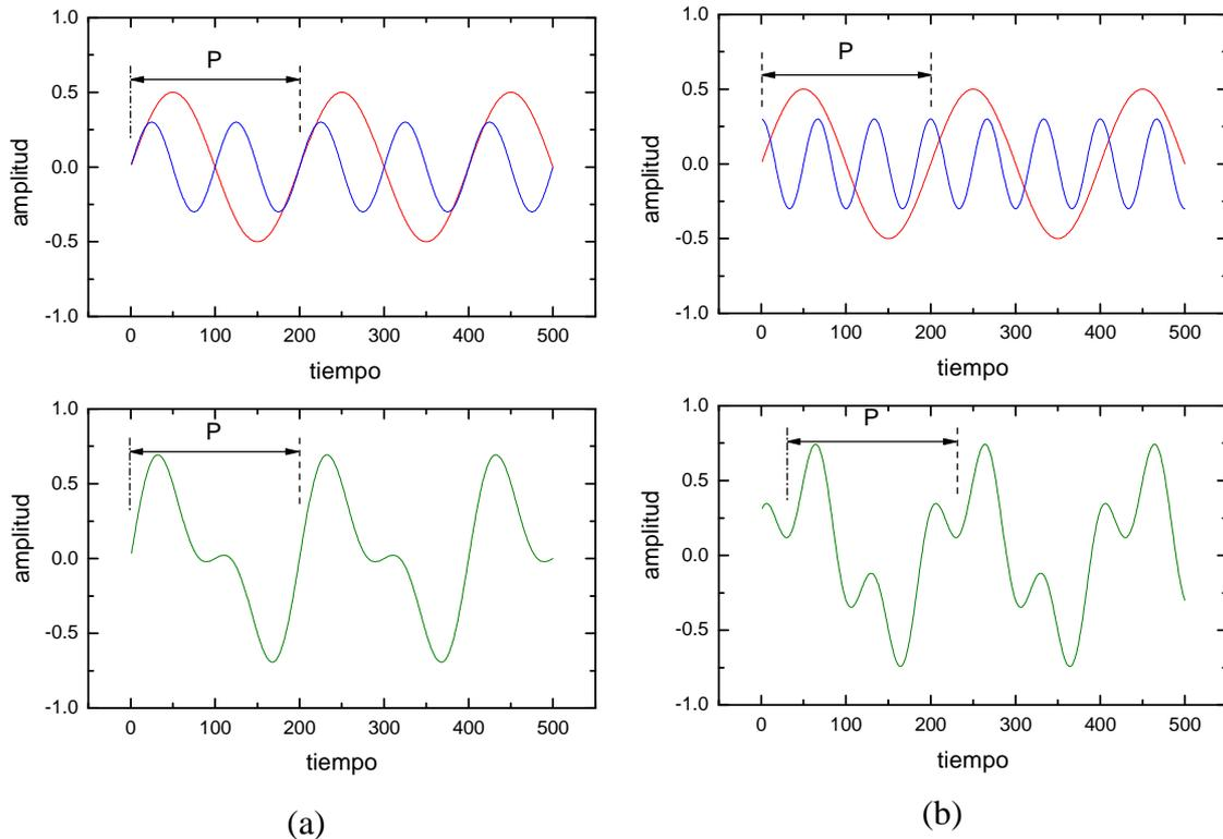
Figura 18: Superposición de ondas armónicas (1) y (2). (a) primer y segundo armónicos, rojo y azul respectivamente, con  $\phi_1 = \phi_2$ . (b) primer y tercer armónicos, rojo y azul respectivamente,  $\phi_1 = 0$  y  $\phi_2 = \pi/2$ . En ambos casos  $A_1 = 0.5$  y  $A_2 = 0.3$ .
