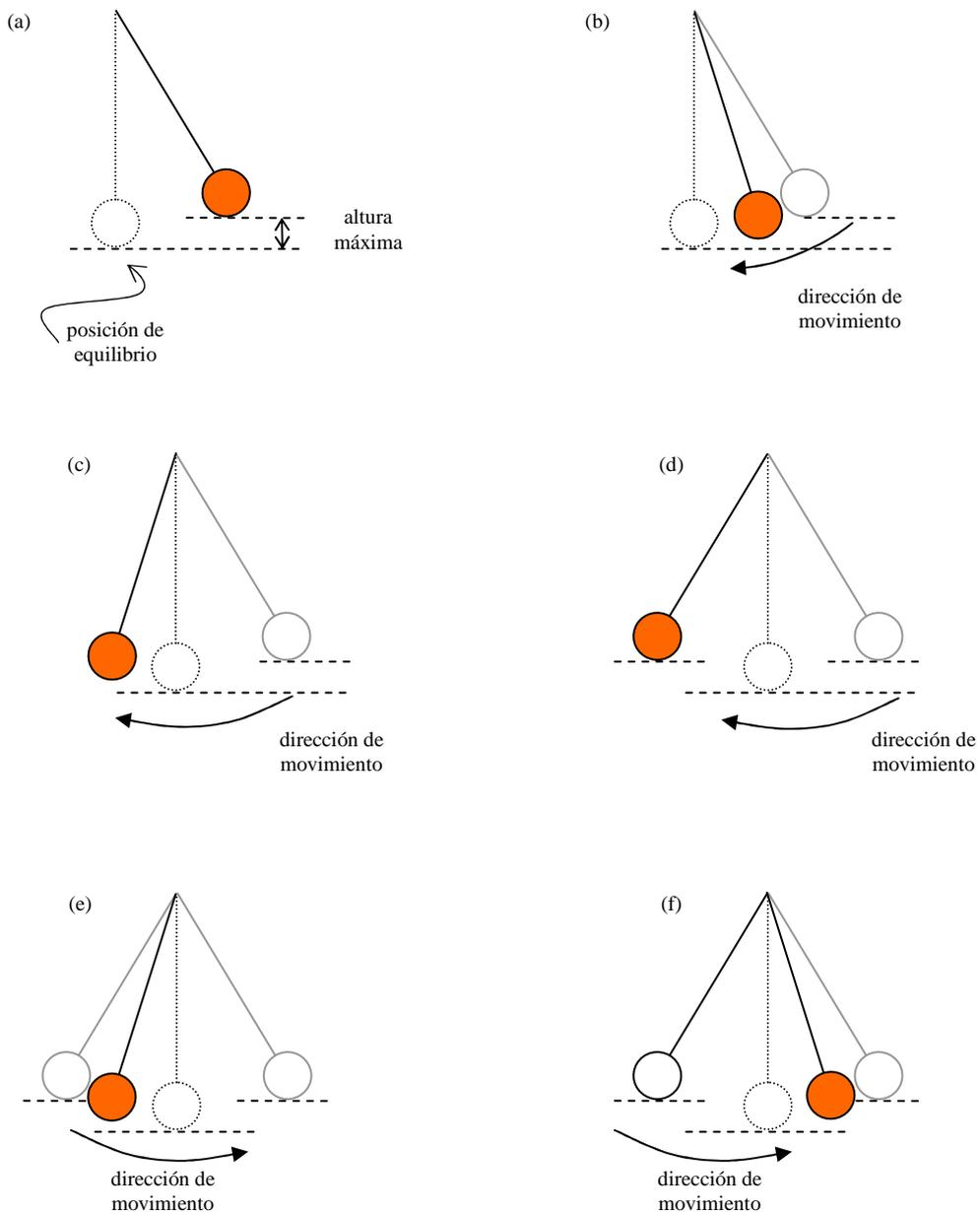
Figura 1: movimiento pendular. Se dibujó en línea de puntos la posición de equilibrio de la pesa.
