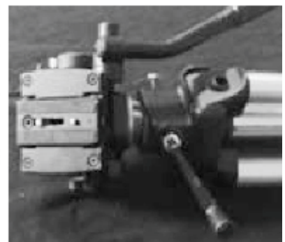
■ Piastra colocada en trípode de cámara
